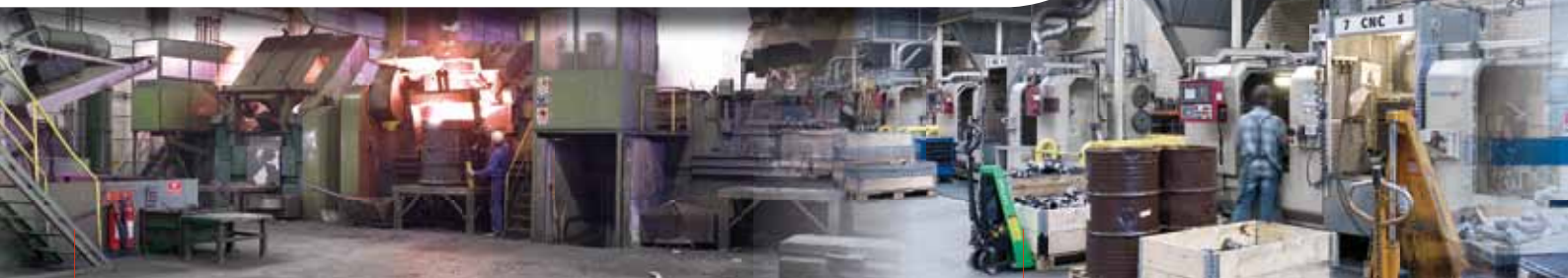
Smältning i elektriska mellanfrekvensugnar.
